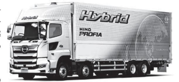
加により、エンジン停止後も冷凍機に電力を供給することで庫内温度を約2時間確保することが可能。モーター出力の向上により、予冷時間を約90分短縮。
