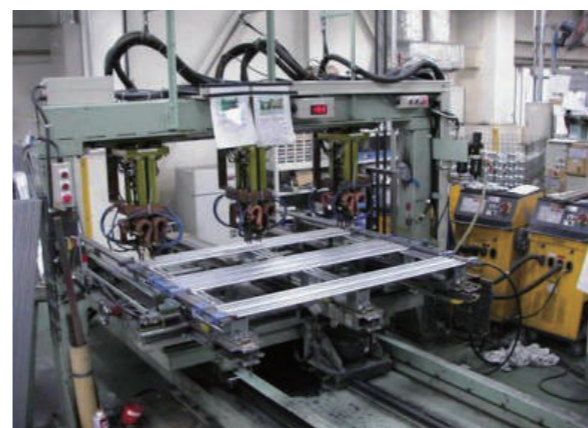
スチールパレットの溶接組立工程(滋賀工場)
